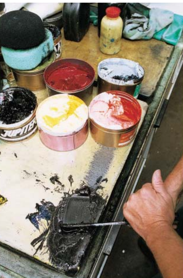
⑤ Nun werden die Lichtdruckfarben gemischt; in der Feinheit der Farbgebung ist das Verfahren unübertroffen. Weil die hiesige Industrie nur noch vier Grundfarben bietet, kommen die lichteichten Leinölfirnisfarben aus England und Japan
